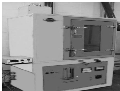
**Figura 41** - Câmara de densidade óptica fechada
