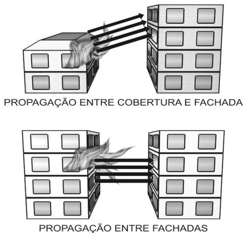
**Figura 30 -** Isolamento por distância de afastamento
