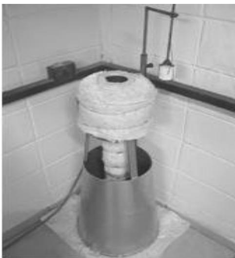
**Figura 42** - Forno cerâmico
