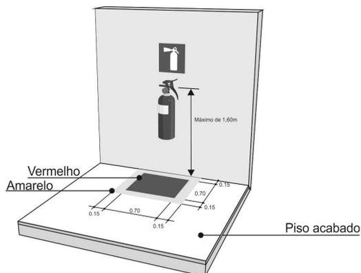
**Figura 62** - Detalhe de instalação de extintores em áreas sujeitas à obstrução
