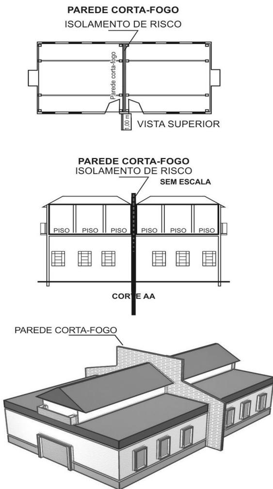
**Figura 31 -** Isolamento obtido por parede corta-fogo
