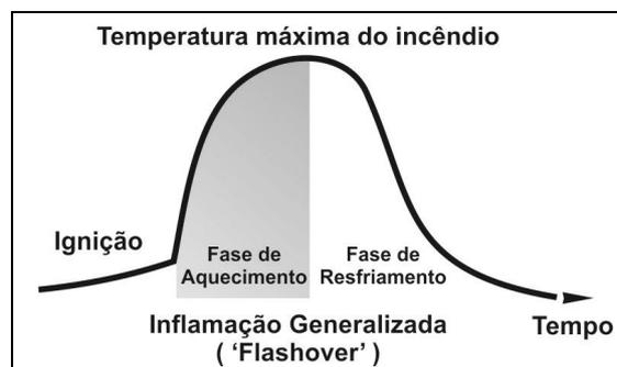
Figura 20 - Curva temperatura - tempo de um incêndio
