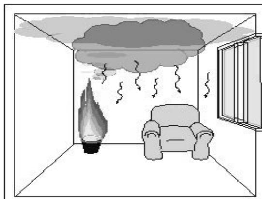
**Figura 21** - Fase anterior ao *flash over* - grande desenvolvimento de fumaça e gases, acumulando-se no nível do teto
