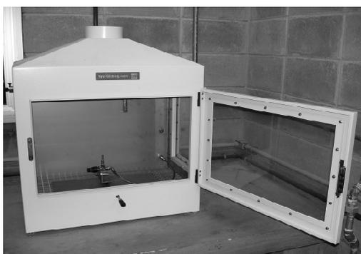
**Figura 44** - Determinação da ignitabilidade dos materiais
