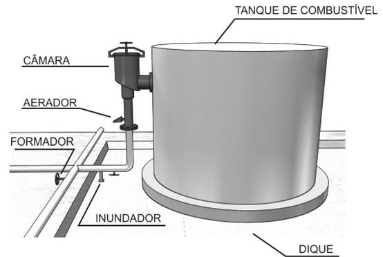
Figura 72 - Detalhe de câmara de espuma
