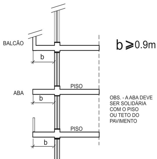
**Figura 34** - Compartimentação por aba horizontal ou balcão
