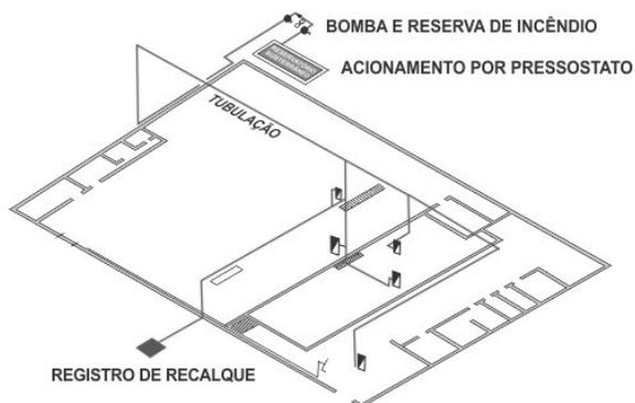
**Figura 65** - Perspectiva isométrica de sistema de hidrantes
