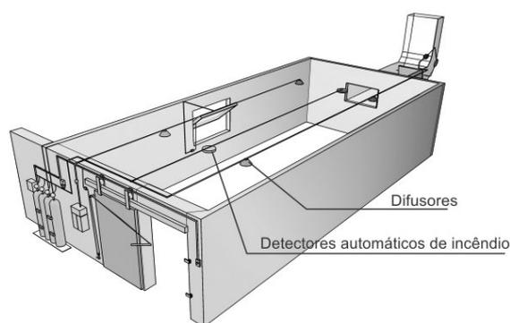
Figura 73 - Sistema de CO<sub>2</sub>
