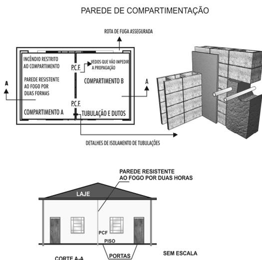
**Figura 32** - Detalhes de parede de compartimentação
