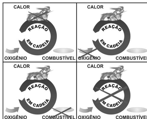
**Figura 19** - Formas de extinção do fogo
