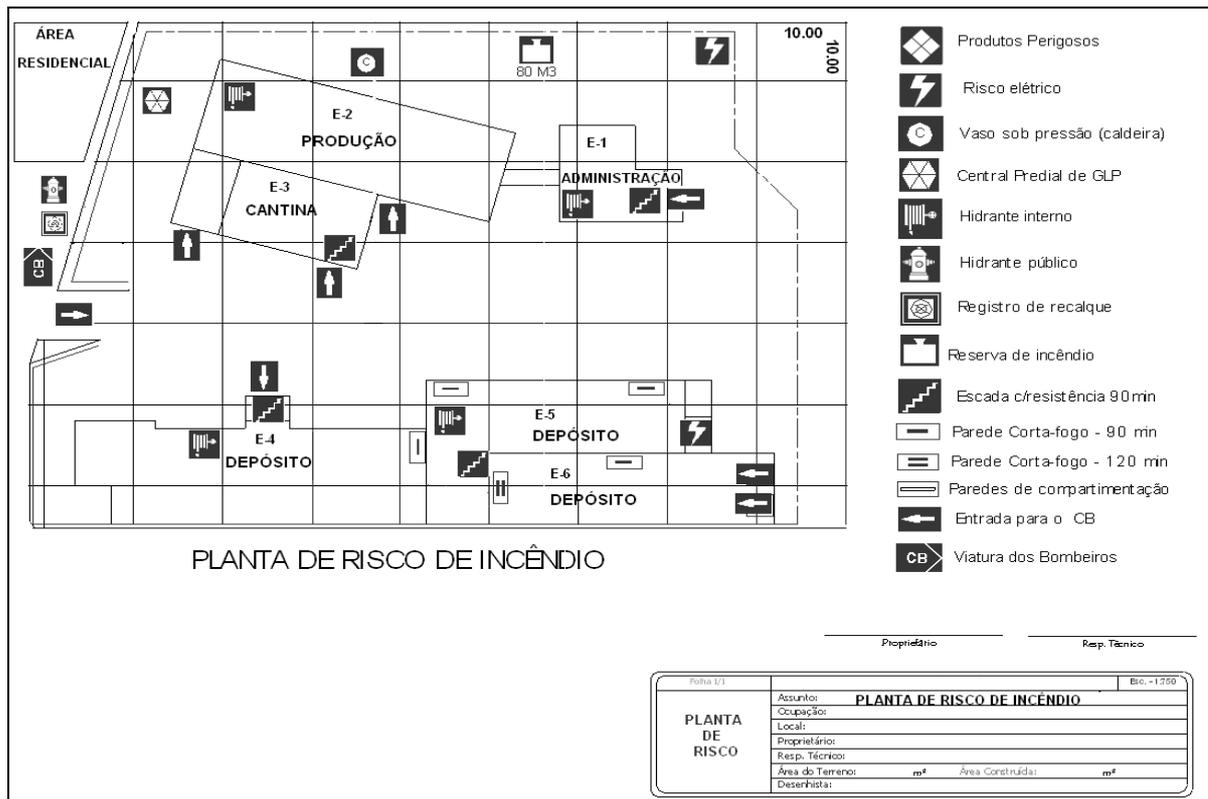
**Figura 75** - Planta de risco. Fonte: IT 01/11.
