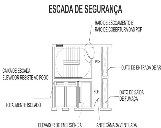
**Figura 51** - Escada e elevador à prova de fumaça
